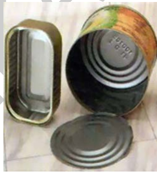
8. ábra: Az ón alkalmazása (fehérbádog)
