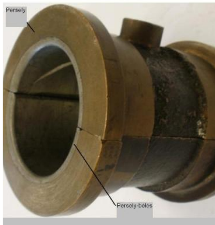
9. ábra: Csúzócsapágó (sárgaréz persely, ónbélés)
