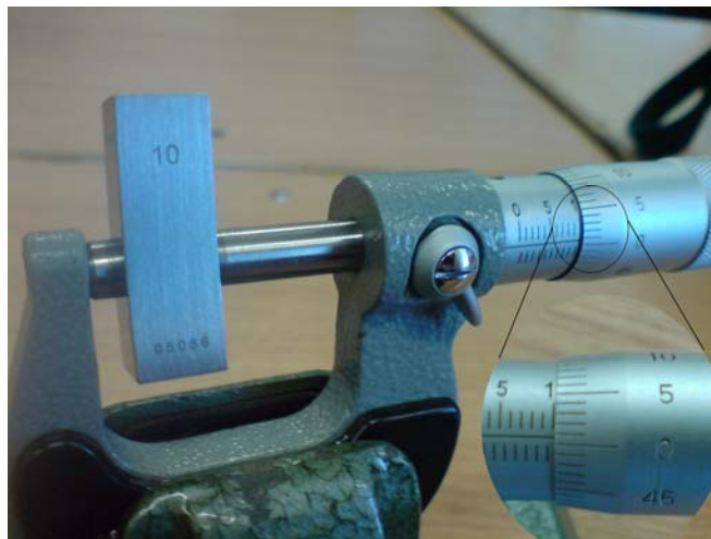
20. ábra: Mikrométer pontosságának az ellenőrzése mérőhasábokkal
