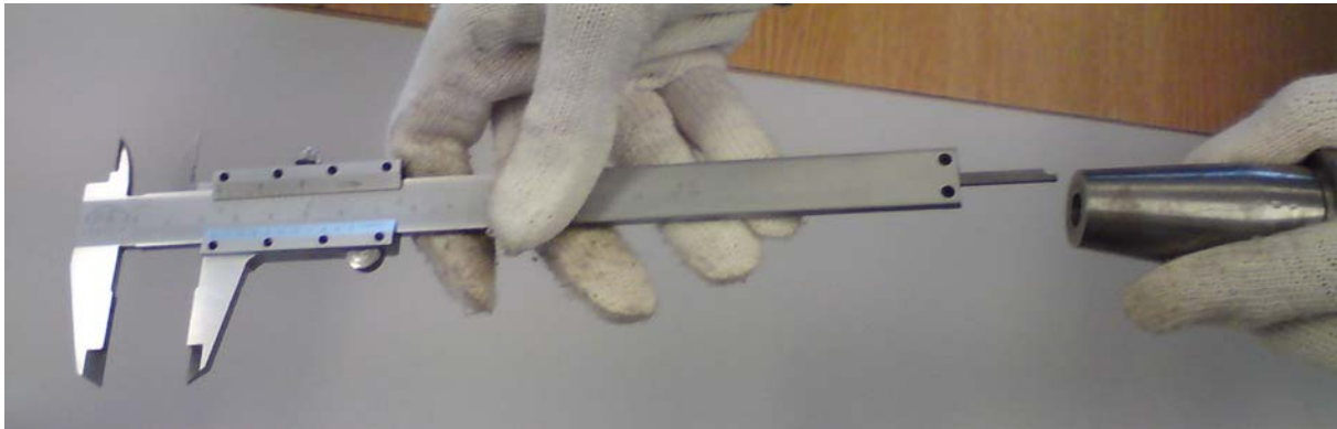
8. ábra: Mélységmérés tolómérővel
