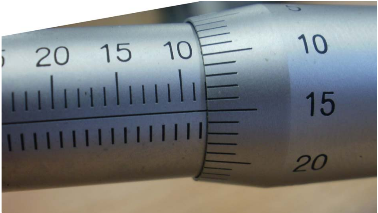
18. ábra: Mélységmérő mikrométer nóniusz osztása
