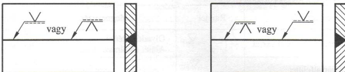
35. ábra. Varrat a nyíl felőli oldalon. (látható) – Varrat a másik oldalon (takart)
