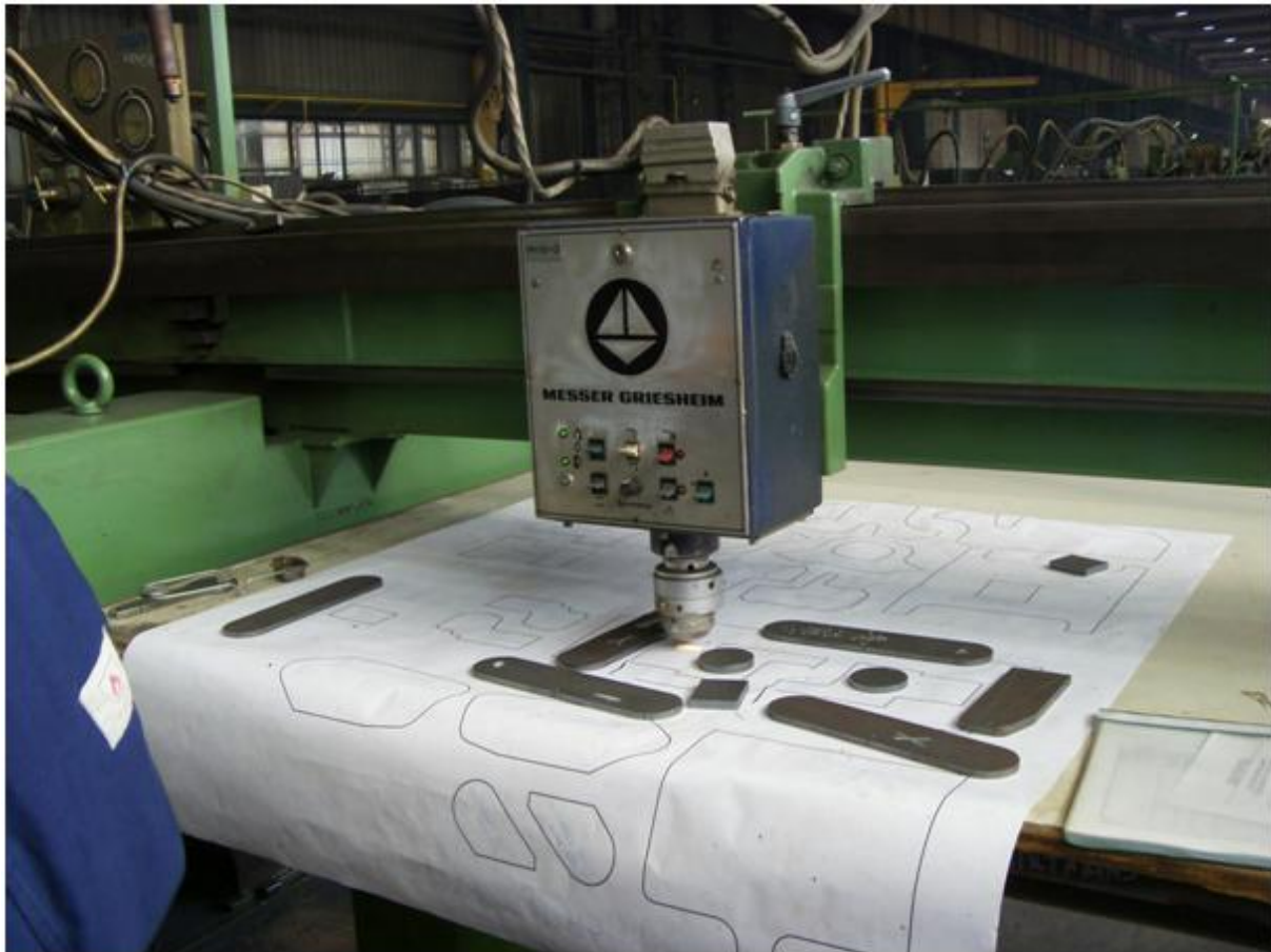
15. ábra. Fotocellás vezérlésű lángvágógép
