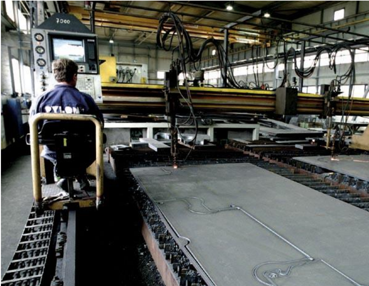
16. ábra. CNC vezérlésű lángvágógép
