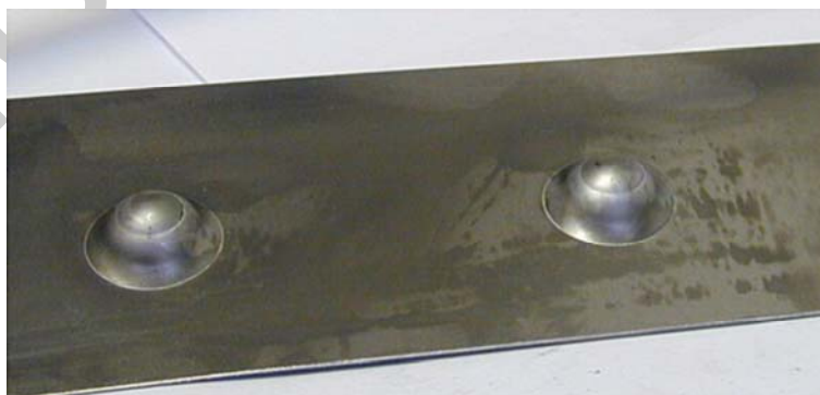
9. ábra. A lemez átszakadásának kezdete
