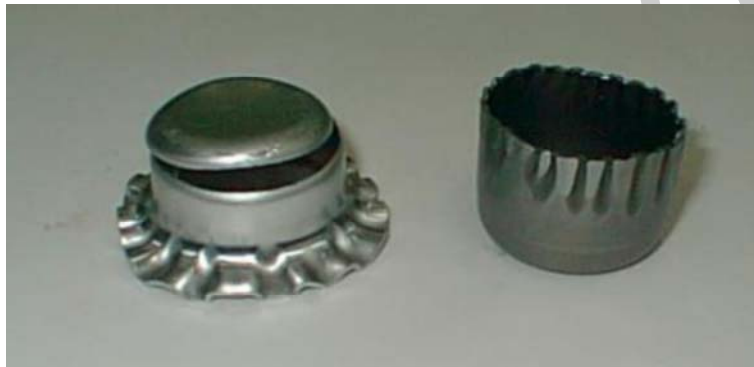
14. ábra. Mélyhúzási hibák: ráncosodás
