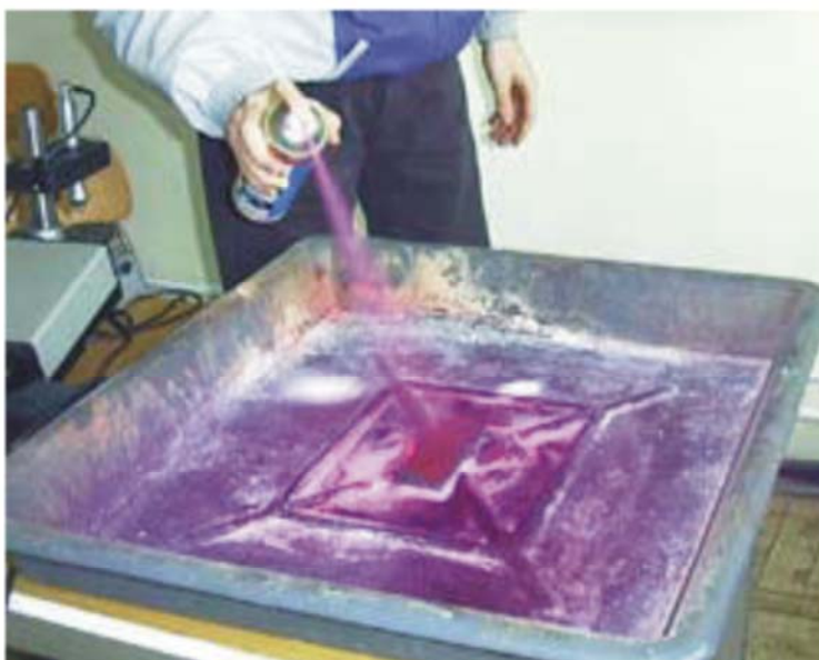
6. ábra. Penetráló jelzőfolyadék felvitele
