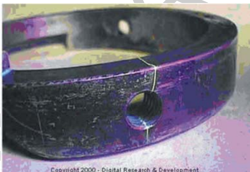
26. ábra. Edzett alkatrészen jól kimutatható hiba, fluoreszkáló eljárással 1.
