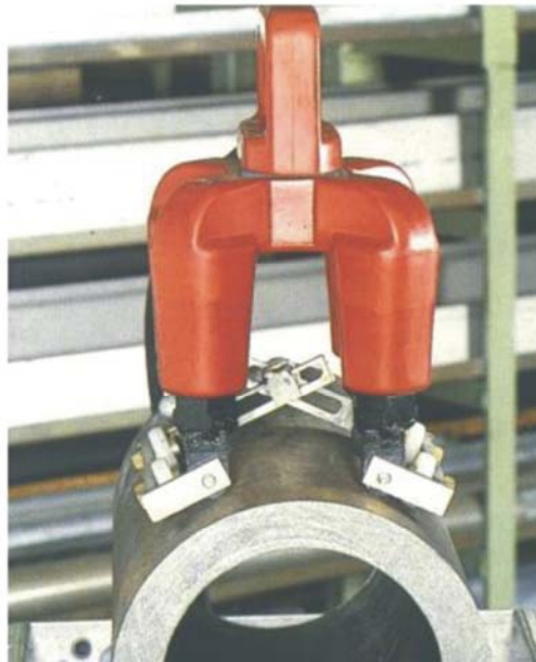
21. ábra. Hordozható mágneses repedésvizsgáló berendezés
