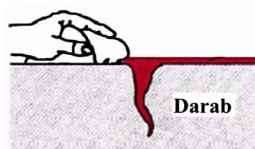
8. ábra. Fölösleges behatoló folyadék eltávolítása
