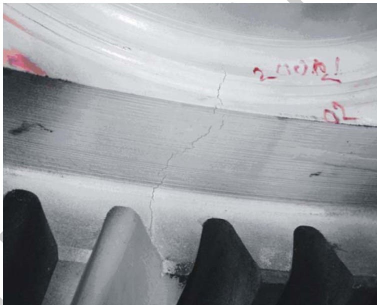
24. ábra. Színkontrasztos (fekete-fehér) mágnesezhető poros vizsgálat
