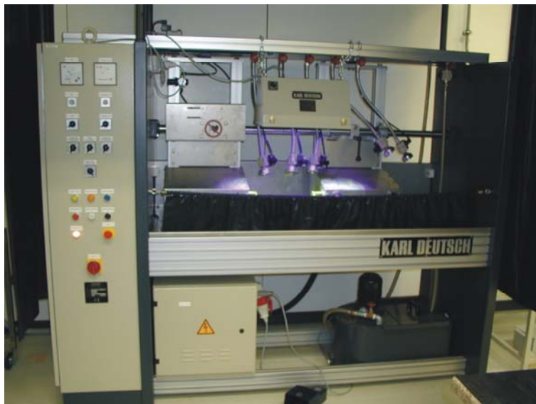
22. ábra. Telepített mágneses repedésvizsgáló berendezés
