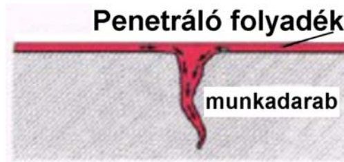
7. ábra. Penetráló jelzőfolyadék nedvesítő hatása
