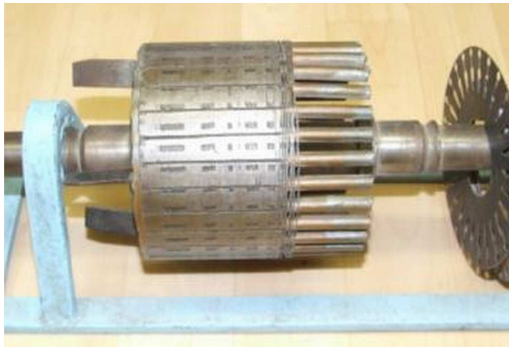
1. ábra. Az aszinkron motor kalickás forgórésze szétszerelt állapotban
