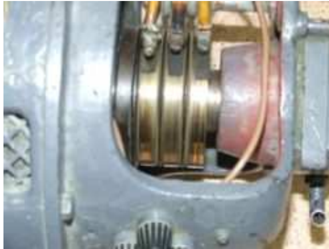
9. ábra. Egy régi csúszógyűrűs gép forgórészének kivezetései a csúszógyűrűkkel és a szénkefékkel
