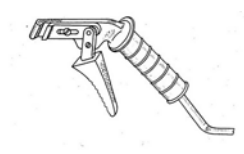
12. ábra. Szorítós elektródafogó 7
