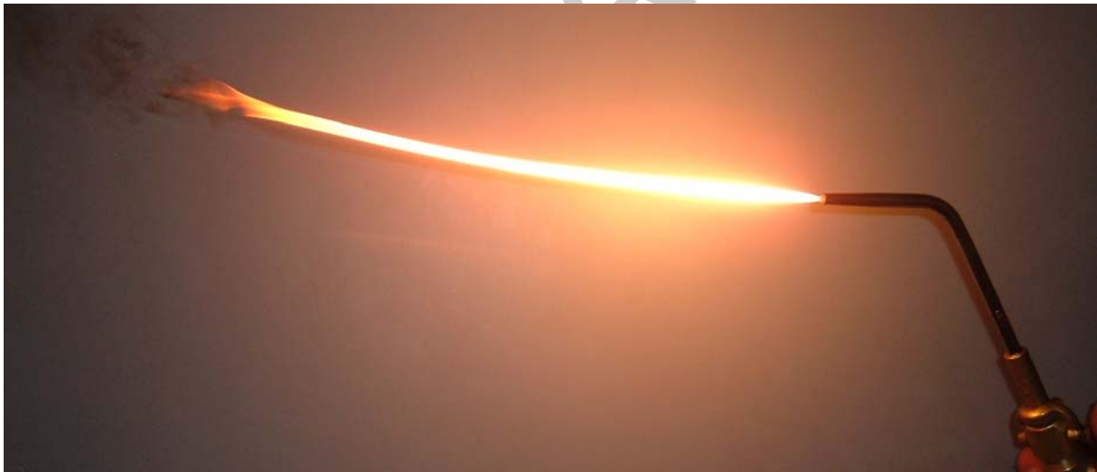
8. ábra. Acetilén dús láng, szinte oxigén nélkül
