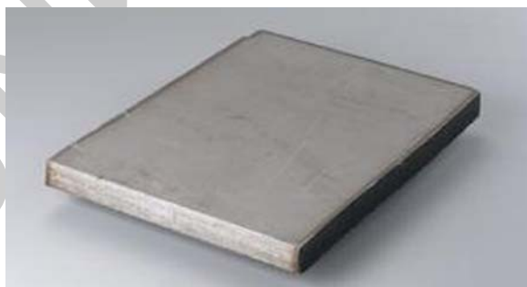
18. ábra. Plazmaívvel kivágott rozsdamentes acéllap
