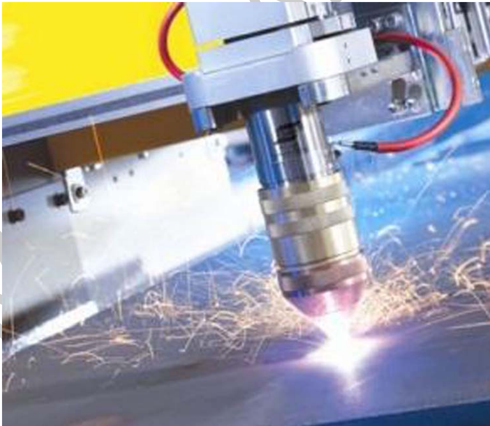
1. ábra. Gépi plazmavágás folyamata
